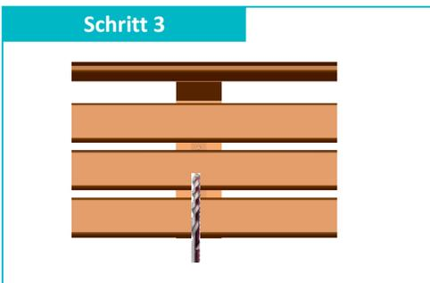
Mit Spiralbohrer ( $\varnothing = 6\text{mm}$ ) durch die Löcher der Verbindungseisen Vorbohrungen in den Bankfüßen vornehmen. (4x Sitzelement - 2x Rückenelement)
