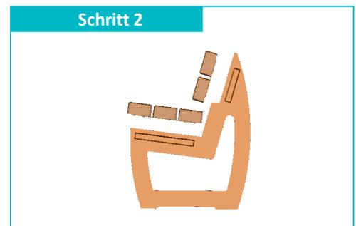
Setzen Sie das Sitz- und das Rückenelement passgenau auf die Bankfüße und sichern diese mit Schraubzwingen gegen Verrutschen.
