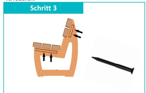
Verschrauben Sie das Sitz- und das Rückenelement mit den Schrauben 6 x 60 mm von unten bzw. hinten durch die vorgebohrten Löcher mit den Bankfüßen.
