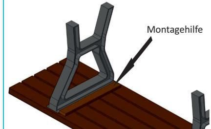
Richten Sie den Tischfuß mittig, mit Hilfe der vormontierten Montagehilfe, an dem Tischelement aus. Die Montagehilfe dient als Anschlag an den Tischfuß.
