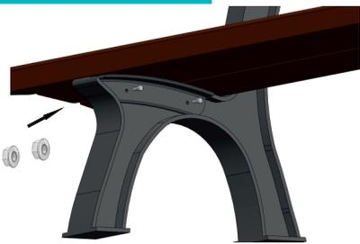
Richten Sie das vormontierte Sitzelement in den Vorbohrungen des Bankfußes aus und verschrauben Sie es mit je 2 Schrauben (M8x30mm), Muttern und 4 Unterlegscheiben pro Bankfuß.
