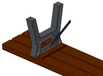
Verschrauben Sie das Sitzelement mit je 6 Schrauben (6x40mm) pro Bankfuß. Anschließend kann die Montagehilfe bei Bedarf entfernt werden.
