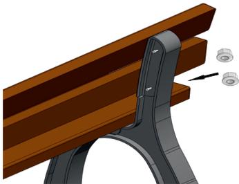
Richten Sie das vormontierte Rückenelement an den Vorbohrungen des Bankfußes aus und verschrauben Sie es pro Bankfuß mit je 2 Schrauben (M8x30mm), Muttern und 4 Unterlegscheiben.
