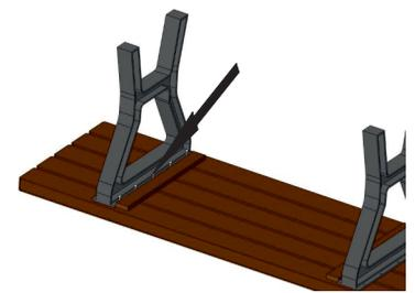
Verschrauben Sie das Tischelement mit je 10 Schrauben (6x40mm) pro Bankfuß. Anschließend kann die Montagehilfe bei Bedarf entfernt werden.
