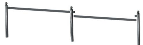
**3.** Zur Positionierung des nächsten Pfostens, die Querholme in die Laschen des bereits positionierten Pfostens und in den danach zu setzenden Pfosten von unten einschieben. Siehe Abb.3
