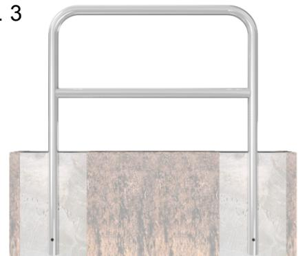
4. Beton hineingeben und ausrichten
