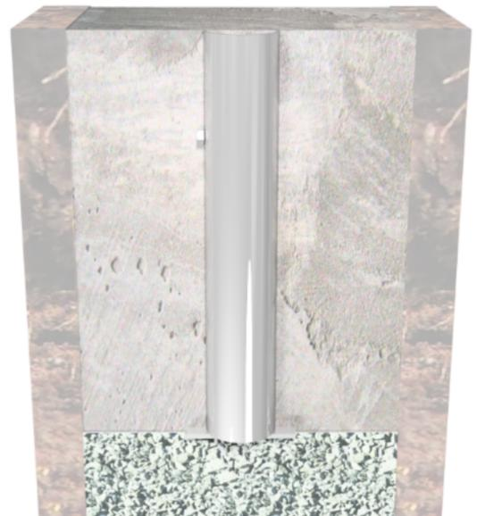
3. Pfosten mit Bodenhülse mittig in das Fundamentloch stellen.
